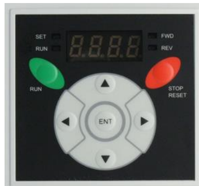
Hình 1 Màn hình biến tần
